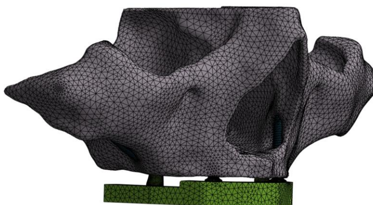
Figura 2 – Modelo matemático mostrando a malha gerada para a simulação.
