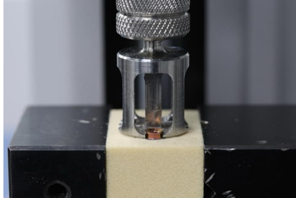
Figura 4 - Equipamento de estática universal Mecmesin Multitest 2.5-XT utilizado para determinação da resistência ao arrancamento axial ( pullout ) com a pinça presa a conexão do implante.
