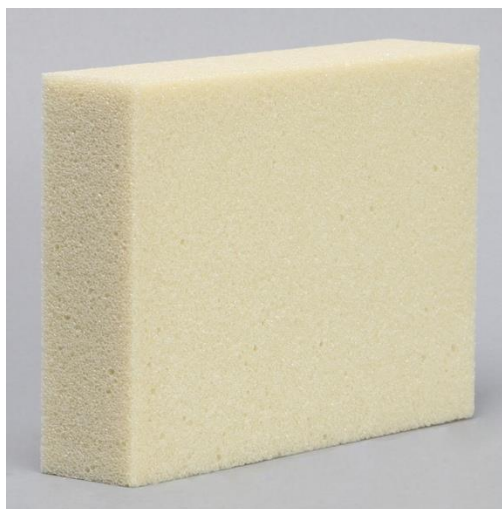
Figura 3 - Bloco de poliuretano representando osso tipo IV (10 PCF), correspondendo a uma densidade de 0,16\text{g/cm}^3 .
