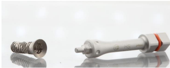
Figura 7 - Implante HS Ø3.75x8.5mm (Neodent) após carregamento estático de torção, juntamente com Conexão HS para catraca. É possível notar o padrão de falha na junção interna do implante.
