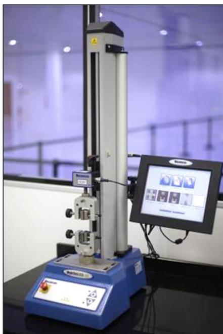
Figura 2. Máquina de tracionamento universal utilizada para o teste de resistência ao arrancamento axial (*pull out*).
